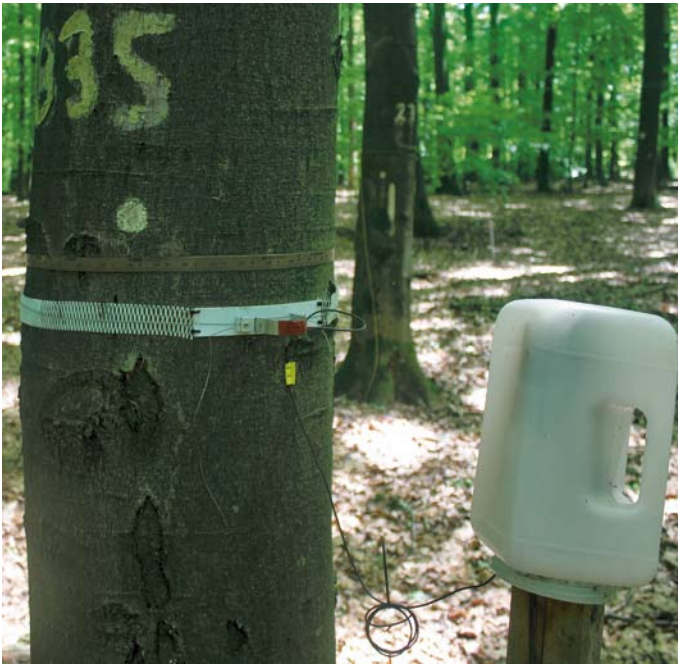
Kontinuierliche (Dendrometer) und periodische (Dauerumfangmessband) Zuwachsmessung im Intensiven Monitoring Foto: J. Weymar
