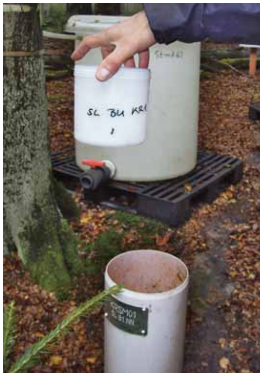
Entnahme eines Schwermetall-Sammelgefäßes Foto: NW-FVA
