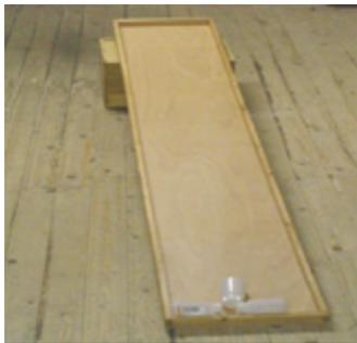
Mit verschiedenen Flüssigkeiten gefüllte Behälter rollen unterschiedlich auf einer schiefen Ebene.
