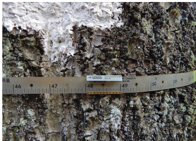
„Mitwachsendes“ Dauerumfangmessband zur millimetergenauen Erfassung des Dickenzuwachses Foto: O. Schwerdtfeger
