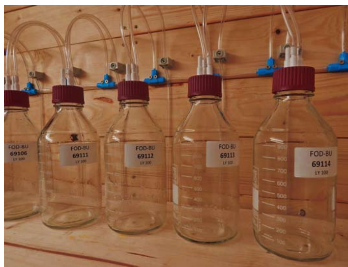
Mit Unterdruck wird Bodenlösung aus verschiedenen Bodentiefen gewonnen Foto: O. Schwerdtfeger
