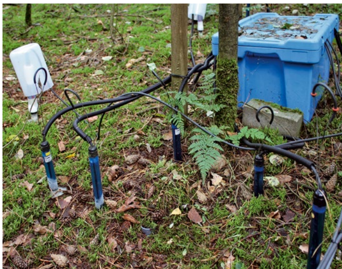
Tensiometer zur Messung der Bodenfeuchte
