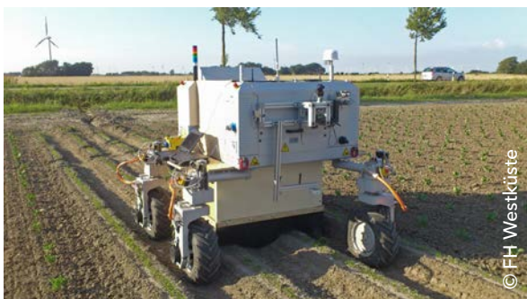
Einsatz des BoniRob zur Beikrautregulierung bei Biomöhren auf den Feldern des Westhofs.
